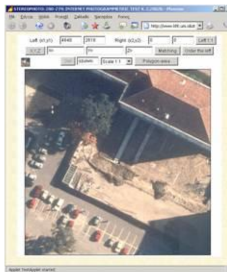
Rysunek 7. Interfejs WWW – wersja 2.2002b systemu – obraz pobrany przez aplet z serwera WWW i wskazanie punktu na zdjęciu lewym.
