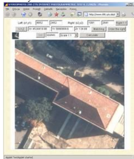
Rysunek 15. Interfejs WWW – 2.2002b – wskazanie wieloboku do obliczenia pola powierzchni - zdjęcie prawe.
