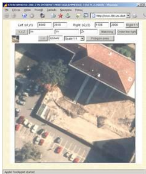
Rysunek 12. Interfejs WWW – wersja 2.2002b systemu – powiększenie i wskazanie punktu na zdjęciu prawym.
