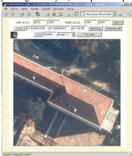
Rysunek 14. Interfejs WWW – 2.2002b – wskazanie wieloboku do obliczenia pola powierzchni - zdjęcie lewe.
