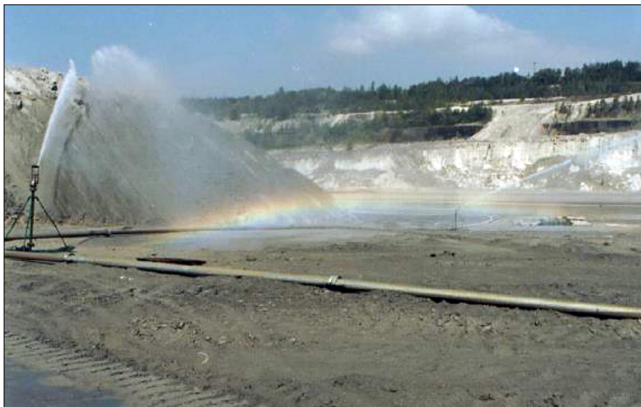
Rys. 2. Zraszanie skarpy czołowej w KWK Turów Fig. 2. Sprinkling of front slope at KWK Turów
