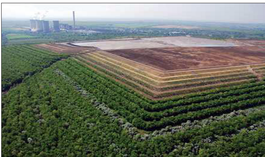
Rys. 6. Składowisko popiołów uformowane z pulpy w Elektrowni Mátra, Węgry
