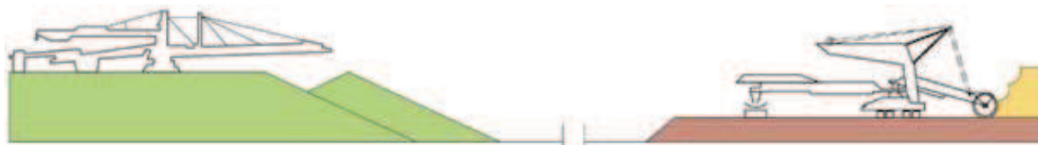
Rys. 1. Schemat układu technologicznego koparka wielonaczyniowa–taśmociąg–zwałowarka taśmowa [opracowanie własne]
