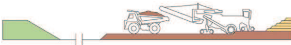
Rys. 6. Schemat układu technologicznego kombajn frezujący – wozidła technologiczne [opracowanie własne] Fig. 6. Scheme of the system of milling excavator – off-highway dump track [own elaboration]
