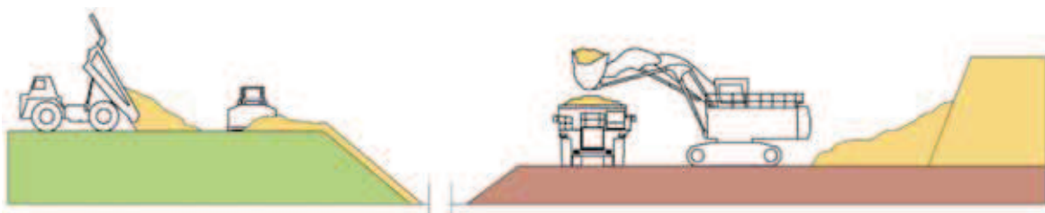
Rys. 4. Schemat układu technologicznego koparka jednonaczyniowa–transport oponowy–spycharka [Opracowanie własne]
