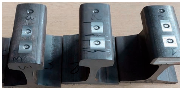
Rys. 4. Odcinki trzech gatunków szyn wykorzystane w badaniach [fot. I. Mikłaszewicz]
