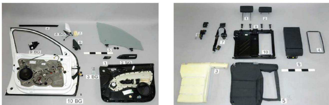
Fot. 2. Instrukcja demontażu – przykład dotyczący przednich drzwi i podłokietnika tylnego siedzenia Skody Octavii [3]
