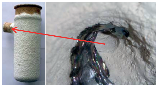
Rys. 3. Tygiel ceramiczny oraz pozostałości metalu w jego kanale wylewowym
