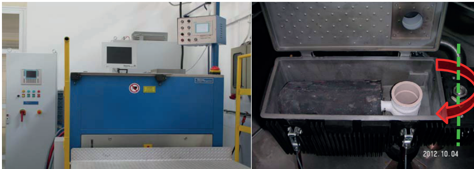
Rys. 2. Indukcyjny odśrodkowy piec próżniowy SuperCast
