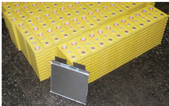
Rys. 6. Widok dwóch typów ogniw litowo-jonowych: Thunder-Sky (żółte ogniwa) i Kokam (srebrne ogniwo); pojemność ogniwa Kokam jest równa połowie pojemności ogniwa Thunder-Sky
