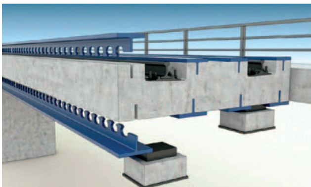
Rys. 8. Przęśta mostów kolejowych w technologii VFR-Rail [5]
