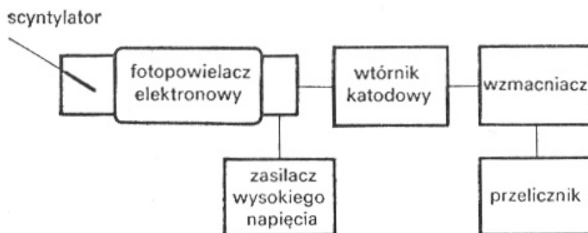
Rys. 8. Schemat blokowy licznika scyntylacyjnego
