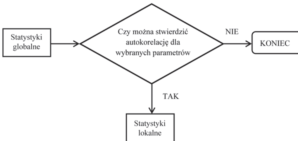
Rys. 1. Schemat blokowy operacji w celu oceny wzajemnej korelacji parametrów łupka
