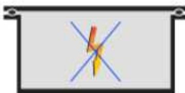
Rys. 4. Symbol graficzny budowy wzmocnionej „e” [7]
