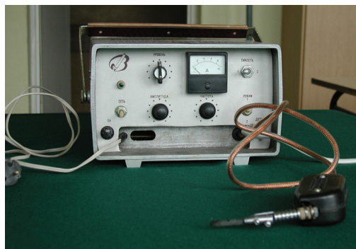
Rys. 2. Urządzenie do nanoszenia powłok elektroerozyjnych EIL-8A
