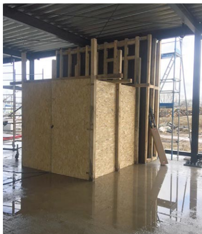
Rys. 2. Przykład komory badawczej w badaniu polowym, źródło: https://badaniaokien.pl/business-garden-wroclaw/
