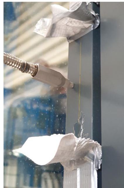
Rys. 4. Czujnik FBG (wraz z mechanicznym czujnikiem przemieszczenia) przyklejony do profilu wycinka fasady zamontowanego w komorze badawczej
