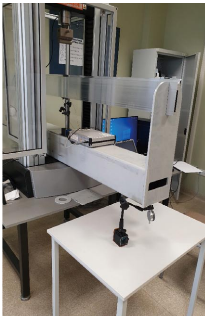
Rys. 3. Stanowisko do kalibracji czujników FBG na maszynie wytrzymałościowej
