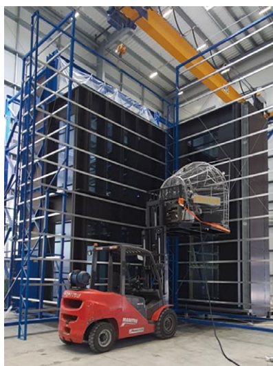
Rys. 5. Komora do badań fasad, okien i drzwi w CBiR Aluprof S.A.
