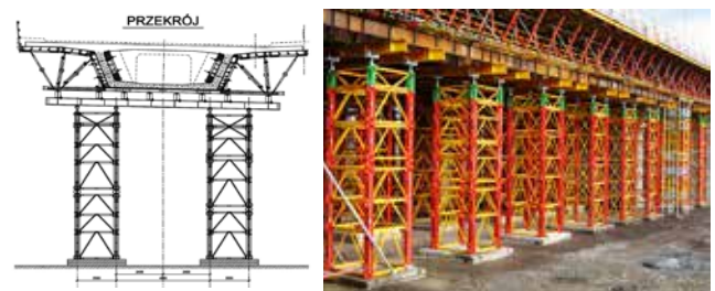
Ryc. 12. Przekrój poprzeczny i widok wież podporowych VST
