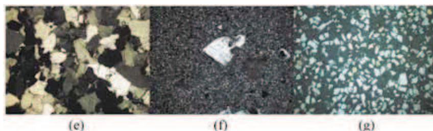
Rys. 3. Piaskowiec z Tumlina (e), porfir z Miękinii (f), ziarna koncentratu miedzi (g) (źródło własne)
