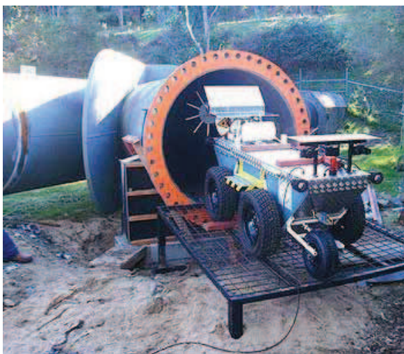
Rys. 2. Widok robota do inspekcji rurociągów z Water Corporation [9]
