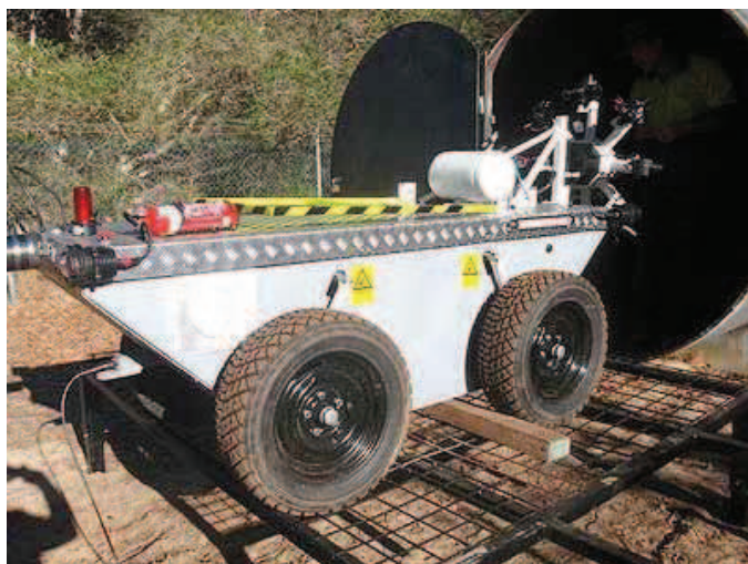
Rys. 2. Widok robota do inspekcji rurociągów z Water Corporation [9]
