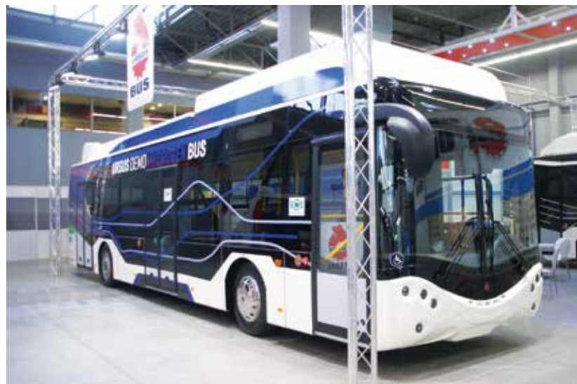
Autobus elektryczny URSUS napędzany za pomocą ognia paliwowych, zasilanych sprężonym wodorem. Fot. Z. Rusak
