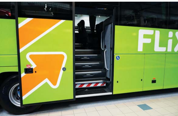
Środkowe drzwi Interlinka z wbudowaną windą, przystosowane do wprowadzenia na pokład osoby niepełnosprawnej
