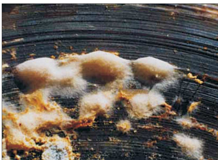
Fot. 1. Taśmy magnetofonowe rumuńskiego radia zaatakowane przez pleśń. Technika radiacyjna okazała się bardzo skuteczna w ratowaniu tych zbiorów
