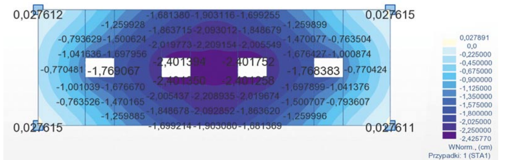
Rys. 11. Mapa przemieszczenia powłoki dla sytuacji quasi-stałej [13]
