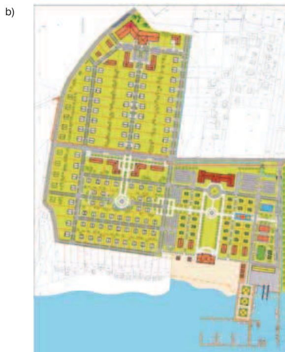
Rys. 6. Założenia do projektu urbanistycznego osiedla mieszkaniowego: a) formuła nakładających się siatek hippodamejskiej i layoutowej, b) kwartałowo-ulicowa struktura urbanistyczna, wyprowadzona z siatki layoutowej (proj., rys. KB, 2015)
