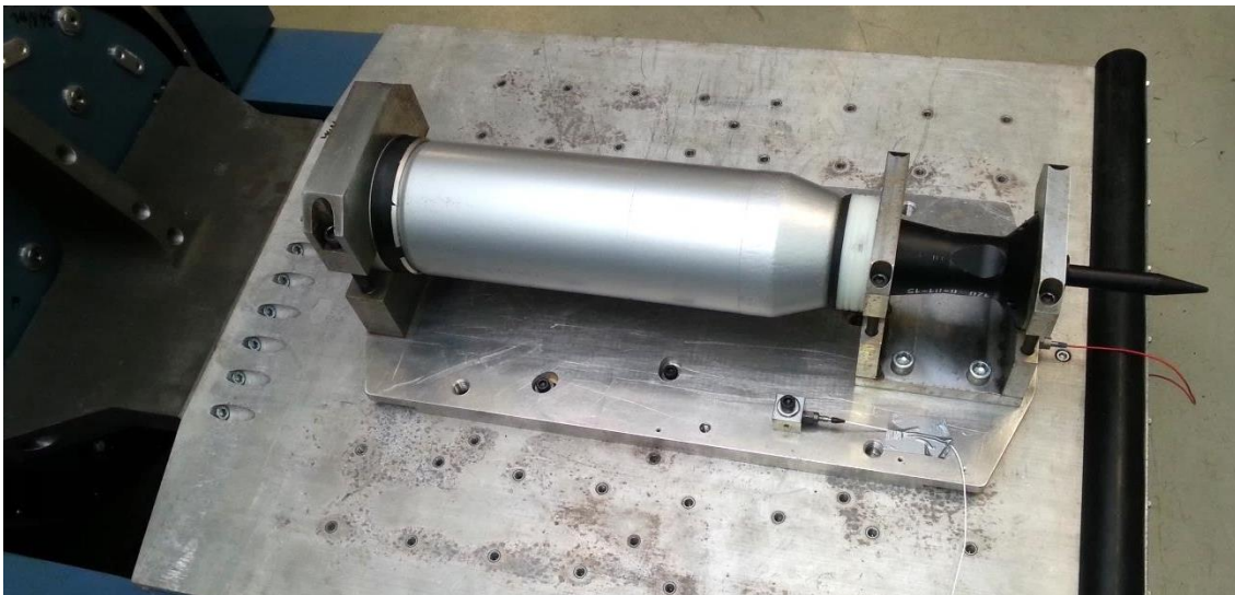
Fot. 3. Test wibracyjny wykonany w osi Z, (wzdłużnie do ruchomych części wzbudnika) na naboju uprzednio termostatowanym w temperaturze +15°C przy zastosowaniu stołu ślizgowego Photo. 3. Vibrating test made by using the slipping table along Z axis (along with the movable parts of inductor) for the cartridge that was previously conditioned at temperature +15°C
