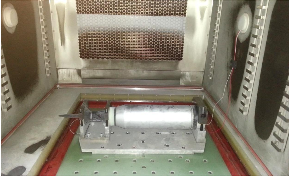
Fot. 1. Test wibracyjny wykonany w osi Z, (wzdłużnie do ruchomych części wzбудnika) w temperaturze -40^{\circ}\text{C} przy zastosowaniu stołu ślizgowego i komory klimatycznej
