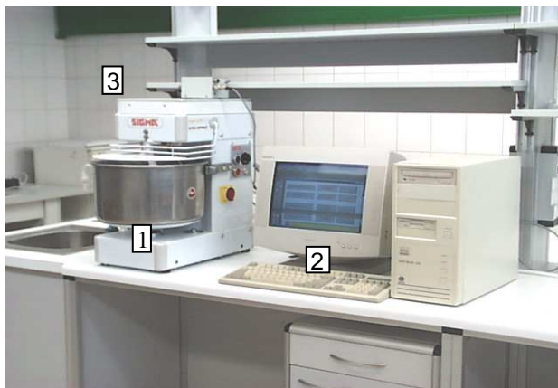
Rys. 1. Stanowisko badawcze do pomiaru procesu miesienia: 1) miesiarka spiralna SIGMA MG12 o zmodyfikowanej konstrukcji, 2) komputer PC, 3) układ elektroniczny pomiaru momentu obrotowego i temperatury
