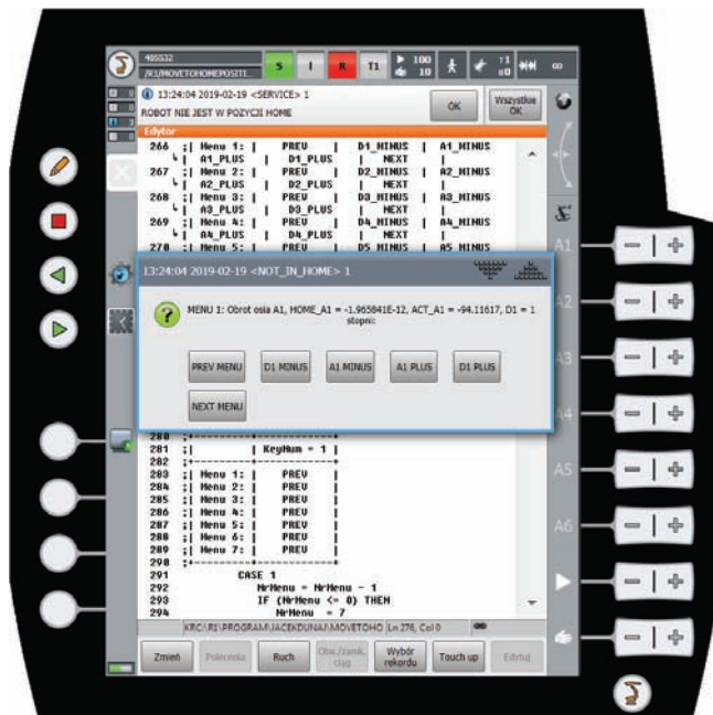
Rys. 3. Panel programowania robota Kuka dla układu sterowania KRC4 z wyświetlonym komunikatem użytkownika oraz z oknem dialogowym do przemieszczania osi A1
