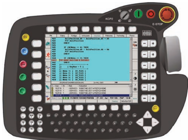
Rys. 1. Panel programowania robota Kuka dla układu sterowania KRC2 z wyświetlonym komunikatem użytkownika
