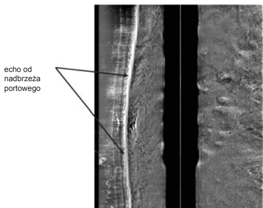
Rys. 3. Pofalowane echo sonarowe od podwodnej części nabrzeża portowego
