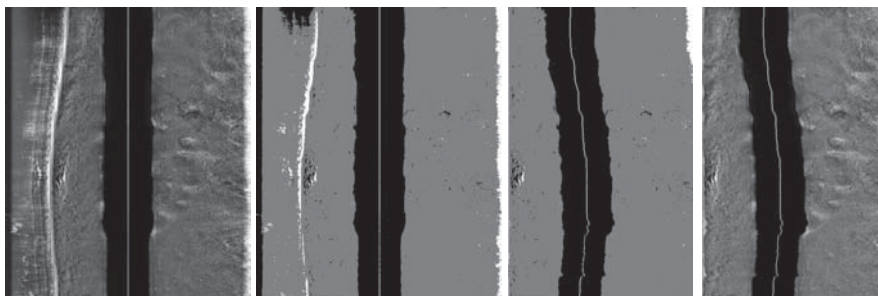
Rys. 5. Etapy przetwarzania obrazu sonarowego (poziom wzmocnienia progowego – 195) Fig. 5. Phases of the sonar image processing (threshold level – 195)
