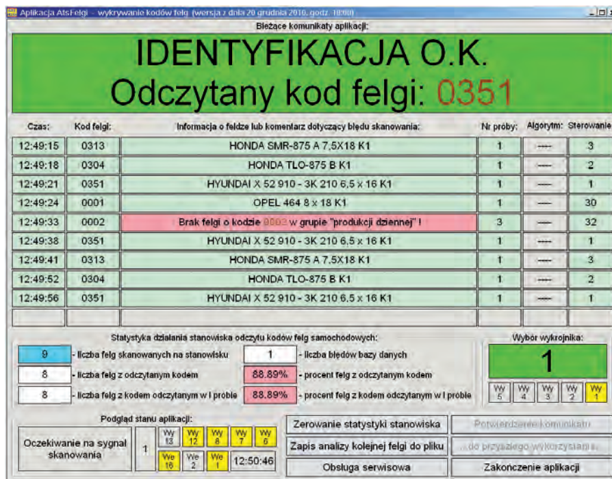
Rys. 9. Główne okno aplikacji do odczytu kodów felg Fig. 9. Main dialog box of PC application for scanning car's wheels codes
