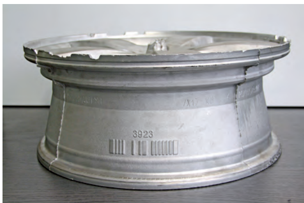
Rys. 1. Odlew felgi samochodowej z kodem FelgenCode V1.3 firmy Numtec
