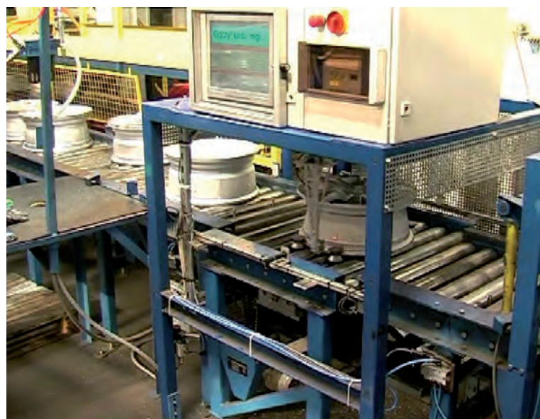
Rys. 5. Stanowisko odczytu kodów felg w działaniu Fig. 5. Car's wheels codes scanning station
