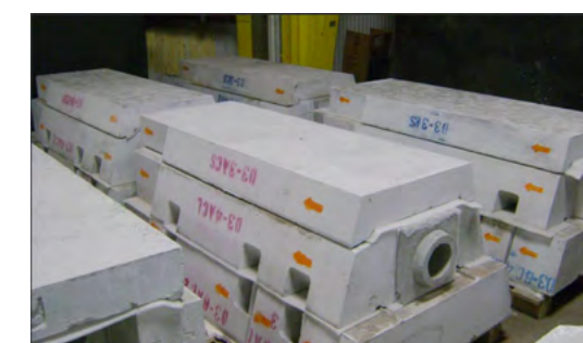
Rys. 8. Moduły do odbudowy trzonu (bateria z bocznym doprowadzeniem gazu)
