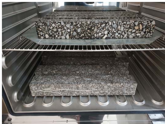
Rys. 3. Porównanie wyglądu próbek MMA po starzeniu długoterminowym (górna półka) oraz po starzeniu krótkoterminowym (dolna półka)
