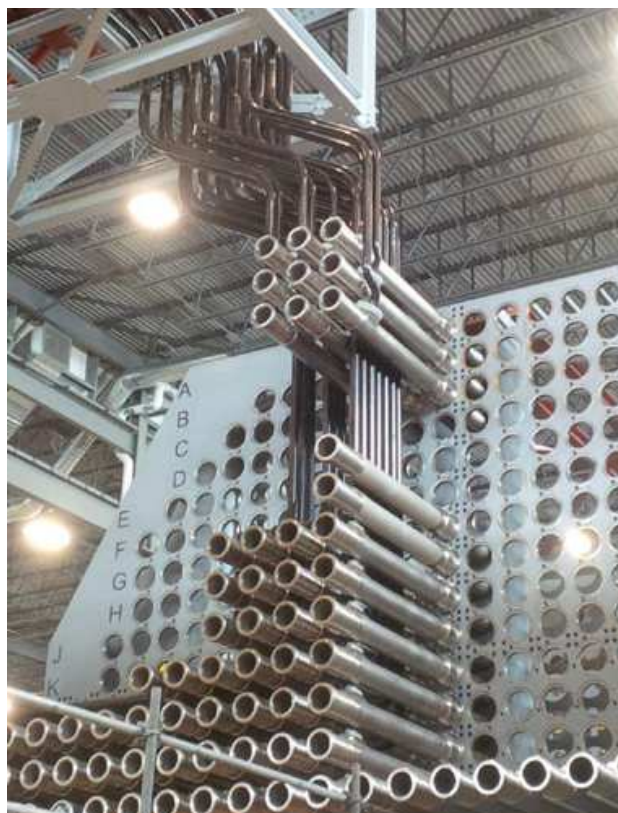
Fot. 2. Makieta Reaktora 2 w elektrowni Darlington (D-2); końcówki kanałów i rury odpływu/dopływu
