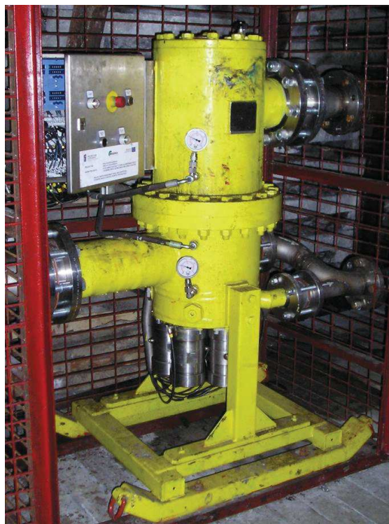
Rys. 1. Filtr samoczyszczący FS-60 produkcji KOPEX Machinery [8]
