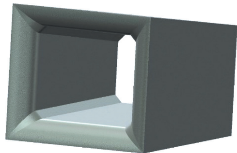
Rys. 8. Proponowany uchwyt do mocowania zęba tnącego czerpaka
