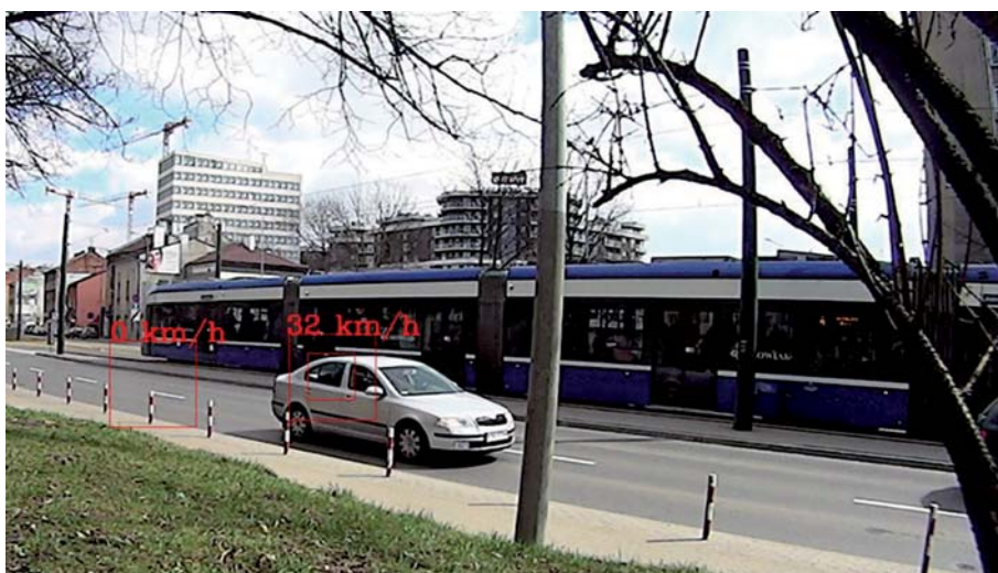
Fot. 3. Bramki po wykryciu pojazdu
