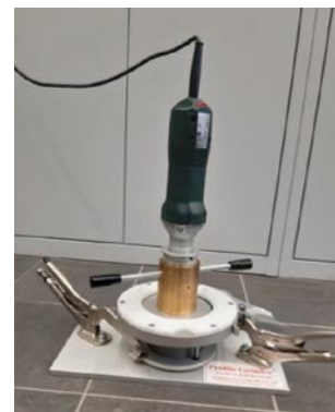
Rys. 6. Ściernica Profile Grinder do precyzyjnego pobierania pyłu betonowego z elementów konstrukcji
