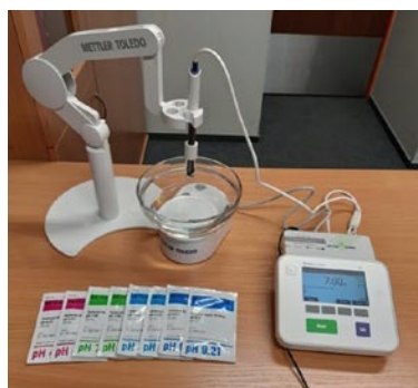
Rys. 5. Miernik Seven Compact do oznaczenia pH w cieczy porowej
