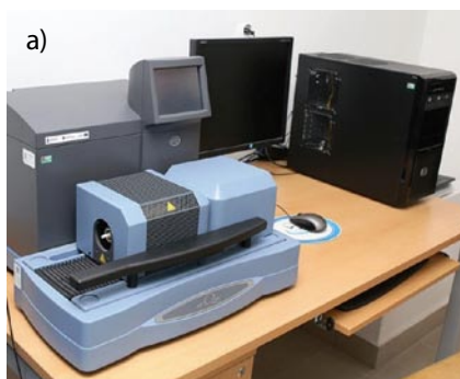
Rys. 8. Analiza termograwimetryczna: a) widok analizatora termicznego TGA/DSC Q600, b) przykład wyników badań termograwimetrycznych wykonanych na próbce betonu
