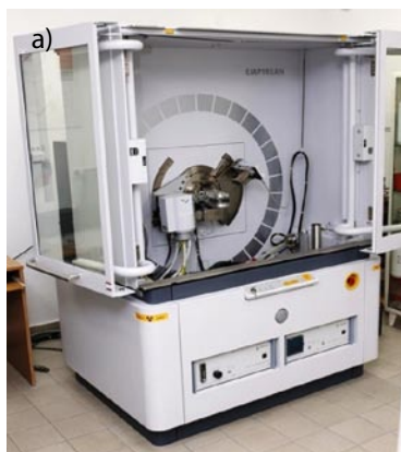
Rys. 7. Dyfraktometr rentgenowski Empyrean firmy PANalytical do badań składu fazowego materiałów krystalicznych (a), przykład rentgenogramów wykonanych dla dwóch próbek betonu różniących się rodzajem użytego cementu: CEM I i CEM III (b)
