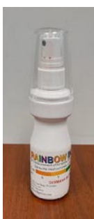
Rys. 4. Buteleczka z odczynnikami w formie aerozolu do wykonania testu tęczyowego
