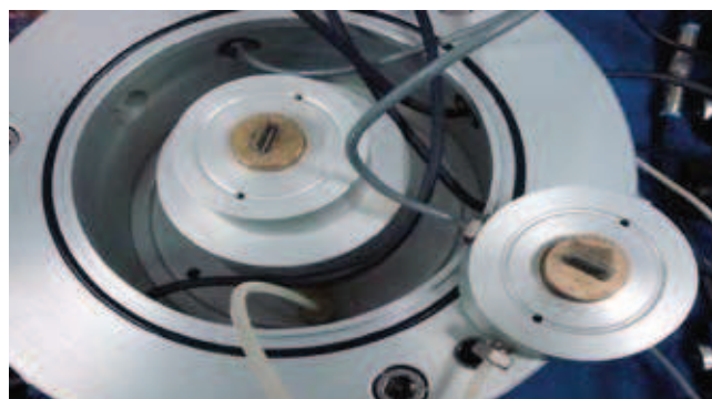
Rys. 3. Widok elementu bender zainstalowanego w cokole komory aparatu trójosiowego ściskania
