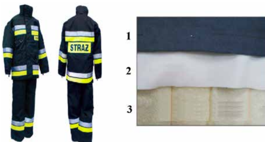
Ryc. 1. Przykładowy wygląd oraz układ warstw ubrania specjalnego
