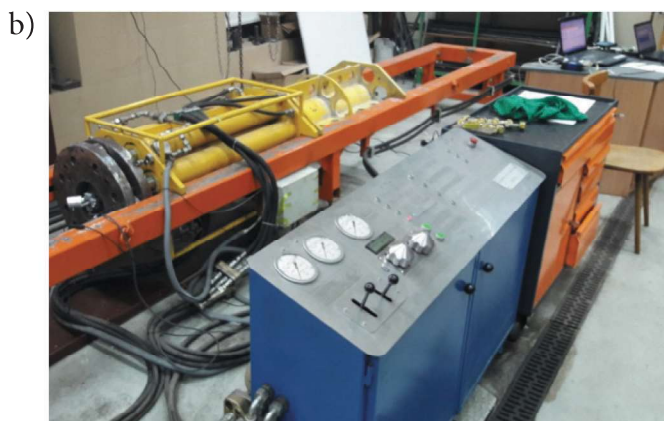
Fot. 3. Badania laboratoryjne obudowy kotwowej: a) elementy systemu SAS, b) stanowisko laboratoryjne do badania obudowy kotwowej (Skrzypkowski 2014)
