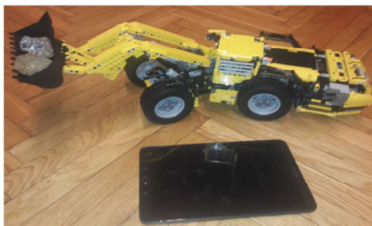
Fot. 10. Model ładowarki kołowo-przegubowej sterowanej z tabletu
