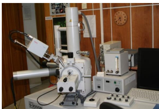
Rys. 2. Elektronowy mikroskop skaningowy Hitachi S-3000N
