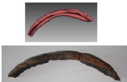
Rys. 7. Wirtualny obraz fragmentu formy w porównaniu z jego rzeczywistym wyglądem
