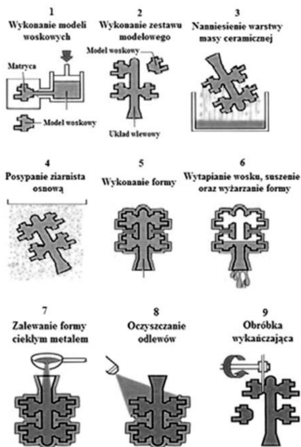
Rys. 2. Etapy przygotowania formy współczesną metodą wytapianych modeli [12]
