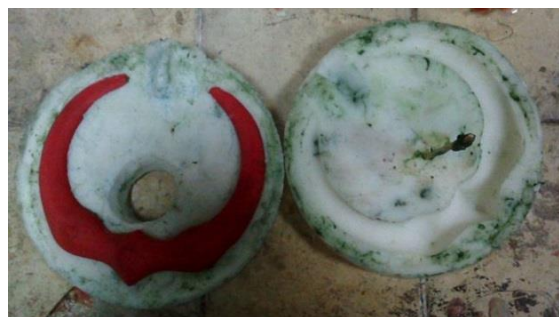
Rys. 11. Gotowa matryca silikonowa po rozłożeniu
