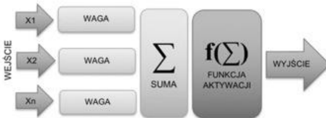
Rys. 1. Schemat sieci neuronowej [9]
