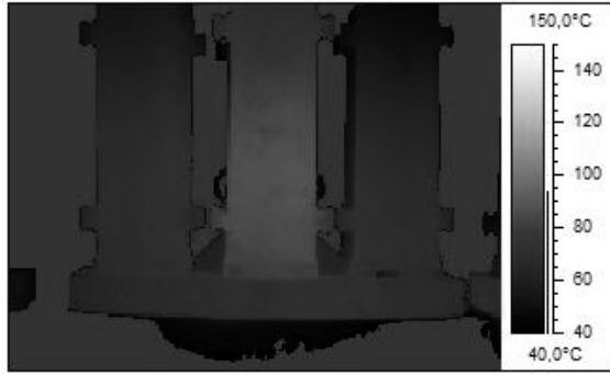
Rys. 4. Termogram obrazujący zestaw wlewnic przygotowanych do zalania płynną stalą [6]
