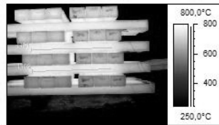
Rys. 9. Termogram obrazujący wlewki ułożone na stosie w sposób tzw. „ciasny” [4]
