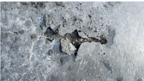
Fot. 6. Widok powierzchni betonu w miejscu odspojenia wierzchniej utwardzonej warstwy – wyraźny brak ciągłości struktury materiału
