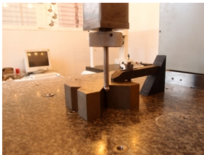
Rys. 5. Skanowanie prostej 2D na manualnej CMM głowicą pomiarową z sztywnym trzpieniem i końcówką sferyczną
