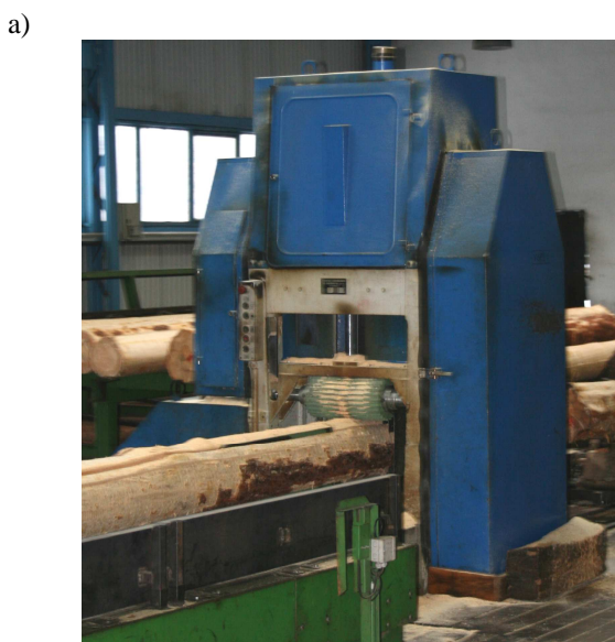
Rys. 2. Pilarka ramowa DTRB-63 (a) i realizowany rozkrój kłody (b) Fig. 2. Frame sawing machine DTRB-63 (a) and applied sawing pattern (b)
