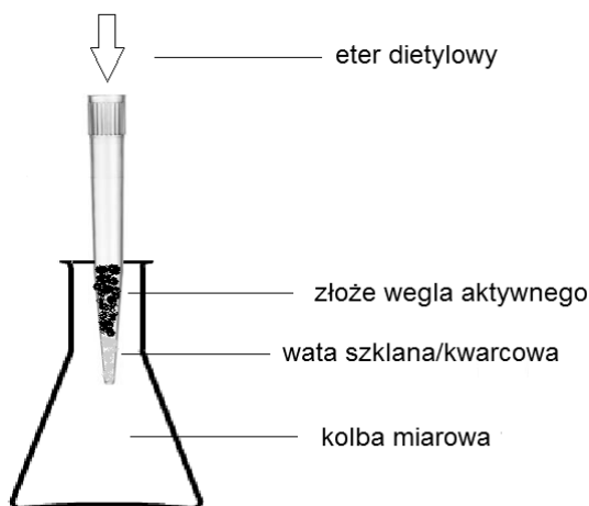
Rys. 3. Schemat desorpcji złoża węgla aktywnego z zaadsorbowanymi gazami metodą przesączania
