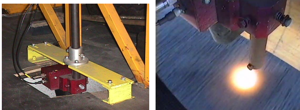
Rys. 7. Głowica pomiarowa Datron DSL1 zamontowana w otworze wewnątrz bagażnika autobusu
