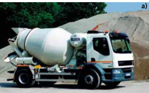
Rys. 2: Betoniarka zabudowana na podwoziu ciężarówki a) 2-osiowej (4 × 2), b) 3-osiowej (6 × 4), c) 4-osiowej (8 × 4)
