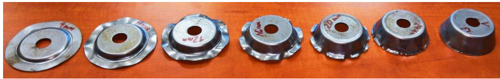
Rys. 4. Poszczególne etapy wyoblania wytłoczki w jednym ruchu rolki
