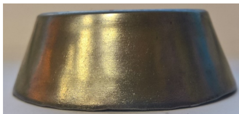
Rys. 9. Wytłoczka uzyskana w badaniach rzeczywistych procesu wyoblania w trzech ruchach
