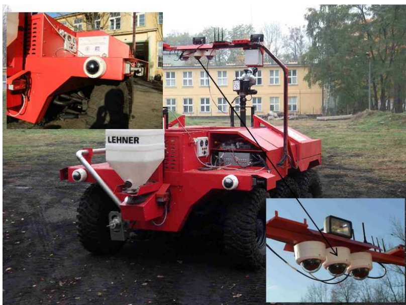
Rys. 4. Rozmieszczenie na pojeździe kamer dedykowanych jeździe do tyłu oraz nadzorowaniu pracy urządzeń dodatkowych
