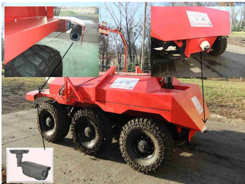
Rys. 3. Rozmieszczenie na pojeździe kamer dedykowanych do jazdy w trudnym terenie
