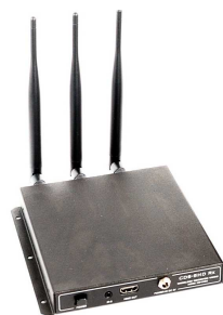
Rys. 6. Podstawowe elementy cyfrowego łącza video: a) nadajnik audio/wideo CDS-5HD TV-Tx, b) odbiornik CDS-5HD Rx
