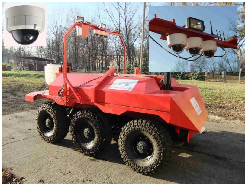
Rys. 2. Rozmieszczenie na pojeździe kamer dedykowanych do jazdy z dużymi prędkościami
