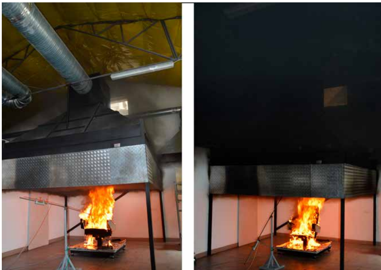
Ryc. 6. Bardzo duże zadymienie hali laboratorium w czasie badania fotela nr 2 na kalorymtrze meblowym (fot. M. Kopański) Fig. 6. Very large smoke in the laboratory during tests for Armchair 2 identified on the calorimeter (fot. By M. Kopański)
