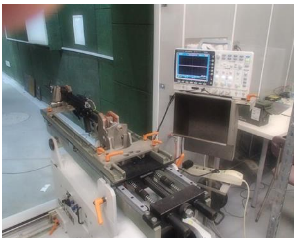
Fot. 4. Bojowy 5.56 mm karabin szturmowy wz. 96 BERYL zamocowany na stole badawczym
