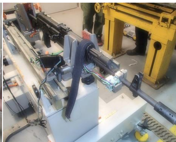
Fot. 5. Kostka z trzema czujnikami akcelerometrycznymi, zamocowana na lufie broni bojowej
